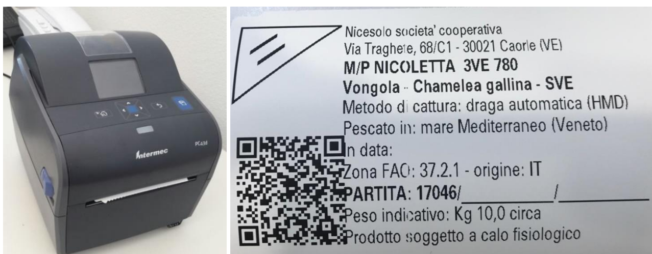
Foto 9.1: Etichettatrice ed etichetta per la tracciabilità a bordo dei motopesca.
