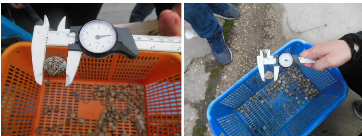
Foto 9.4: Controllo delle vongole non trattenute dal setaccio - conformità con la taglia minima.
