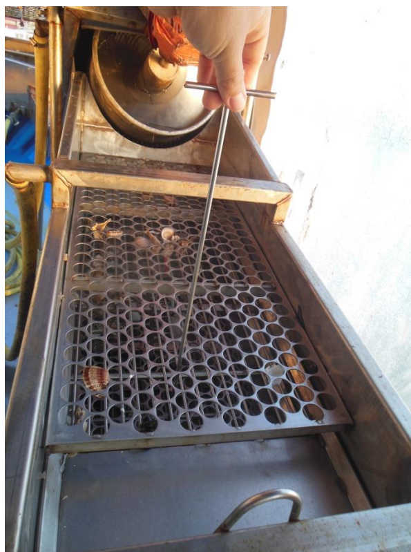
Foto 9.2: Controlli del corretto settaggio del vibrovaglio.
